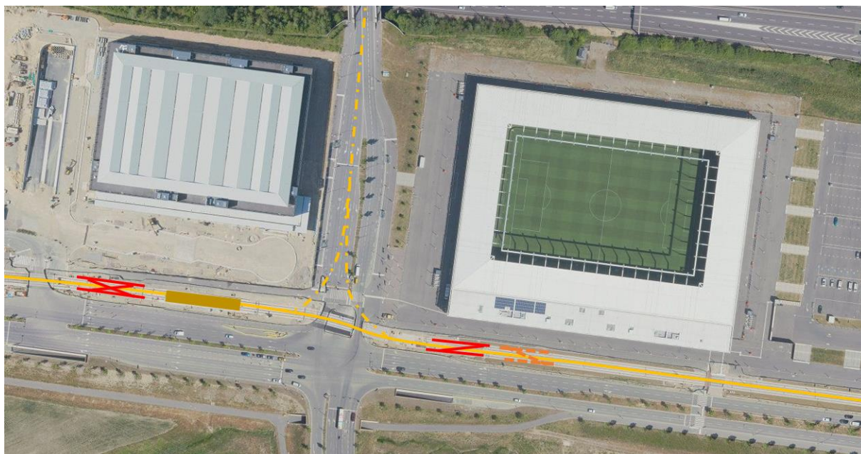
Figure 15 : Raccordement Stade - Proposition localisation des demi californiens pour réaliser la voie unique (sera approfondi en APD ; aiguillages existants en rouge et proposition de demi californien en orange)
